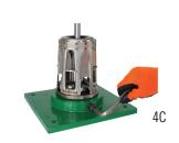
Place BOTTOM STAGE IMPELLER on Shaft
